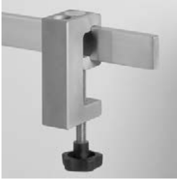
19799-03 Leichtmetall-Klemmsockel Spannweite 35 mm, für ein Schraubstativ mit \varnothing 16 mm/M10, für Schienen 25/35 x 8/10 und Rohre \varnothing 12 - 35 mm. Clamp socket made of light metal, holding width 35 mm, for screw stand \varnothing 16 mm/M10, for rails 25/35 x 8/10 and tubes \varnothing 12 - 35 mm.
