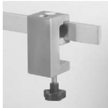
19799-06 Leichtmetall-Klemmsockel Spannweite 50 mm, für ein Schraubstativ mit \varnothing 16 mm/M10, für Schienen 25/35 x 8/10 und Rohre \varnothing 12 - 35 mm. Clamp socket made of light metal, holding width 50 mm, for screw stand \varnothing 16 mm/M10, for rails 25/35 x 8/10 and tubes \varnothing 12 - 35 mm.
