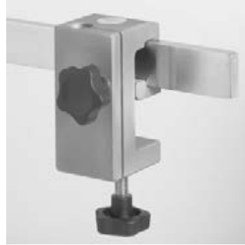
19799-04 Leichtmetall-Klemmsockel Spannweite 50 mm, für ein höhenverstellbares Stativ \varnothing 16 mm, für Schienen 25/35 x 8/10 und Rohre \varnothing 12 - 35 mm. Clamp socket made of light metal, holding width 50 mm, for height-adjustable stand \varnothing 16 mm, for rails 25/35 x 8/10 and tubes \varnothing 12 - 35 mm.
