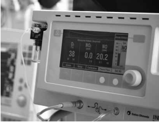
FIGURA 1. Sistema de suministro de óxido nítrico con analizador en la línea de entrada. Nótese que los niveles de óxido nítrico (NO) y de dióxido de nitrógeno (NO 2 ) se muestran en ppm.
