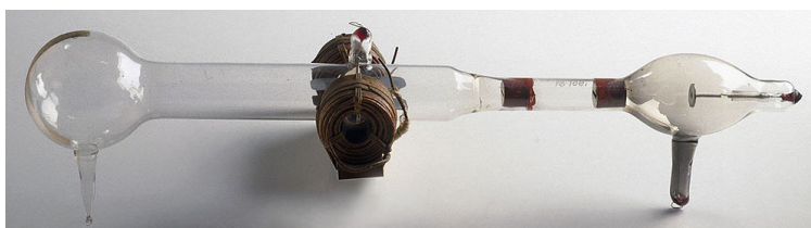
Figura 5.1. Uno de los tubos con los que J. J. Thomson midió la relación masa/carga del corpúsculo, más tarde, llamado electrón.
